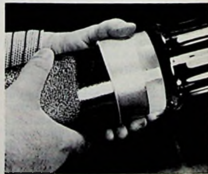
Silicium buis met een inwendige diameter van 75 mm met een conisch deel van 86/50 kwarts wordt in een standaard kwartsverbinding gestoken.
